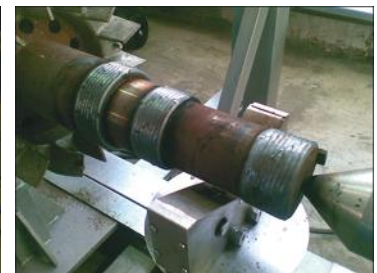
Наплавленный вал ротора электродвигателя
