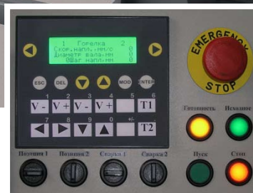
■ Рис. 3. Переносной пульт управления.
