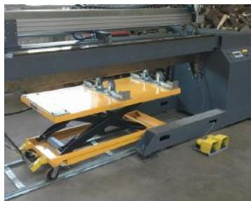
Рис. 6. Устройство загрузки обечаяк на установке АС308-2500
